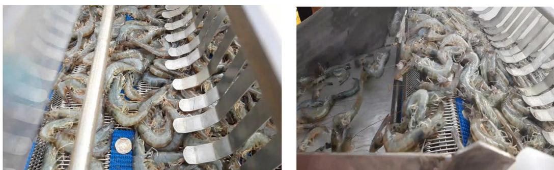
**Figure 3 : crevettes au contact des électrodes**
