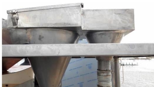
**Figure 2 : alimentation à double entrée permettant de déverser les crevettes sur le tapis roulant du dispositif d'étourdissement**
